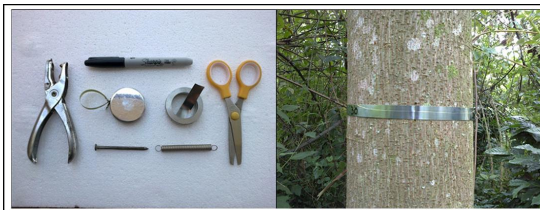
Figura 2. De lado izquierdo, materiales para la elaboración e instalación de bandas dendrométricas. De lado derecho una banda dendrométrica instalada en fuste de Trema micrantha .
