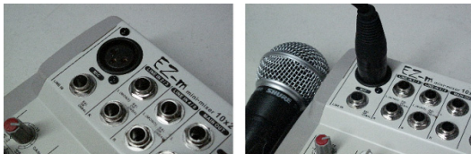
Conexión de micrófono a entrada XLR
